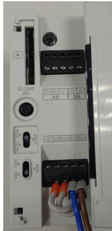
II. 将FX5U左方 COM(RS485 A, B)与转换模块(1, 2)对接
